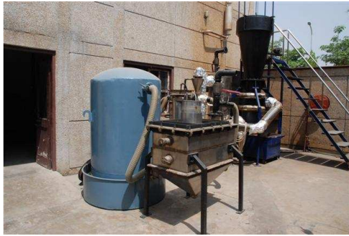
Figure 6 - La machine à gaz de synthèse du centre de conférence de TERI à Gurgaon (banlieue de Delhi)
