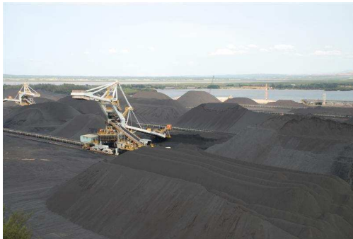
Figure 8 – Stockage en piles dont les plus grosses pèsent jusqu'à 120 000t.
