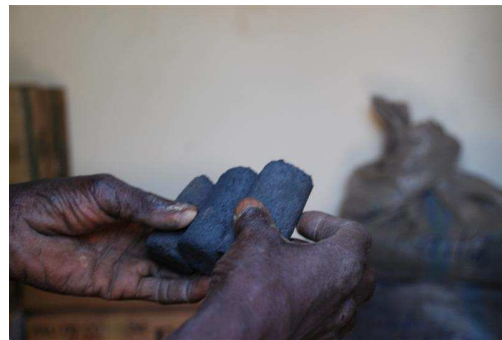
Figure 6 – Combustible fabriqué à partir de paille et de boue.
