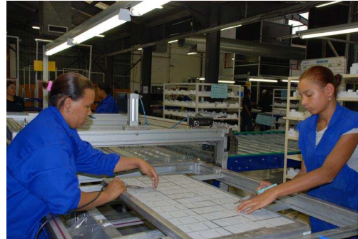
Figure 7 – Atelier d'alignement des cellules photovoltaïques et de soudure.
